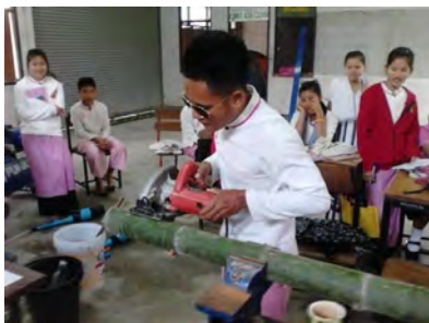
ฝึกอบรม การใช้เครื่องอัดน้ำยาฆ่าเชื้อ นักเรียน รร.แม่ต๋อน วิทยาคม อ.อมก๋อยเพื่อนำไปใช้สร้างเตียงในหอพัก
