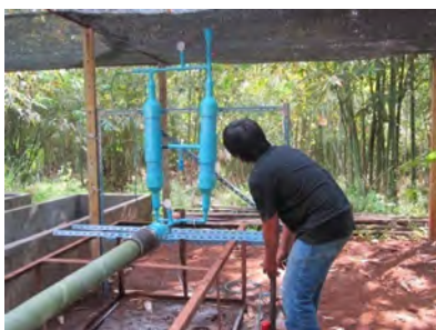
ความสามารถและเงื่อนไขจำเพาะ เครื่องอัดน้ำยาฆ่าเชื้อ ได้แก่ ระยะเวลาในการอัดน้ำยา, ความยาวไม้ไฟ, เส้นผ่านศูนย์กลาง ณ ศูนย์ปางตะ
